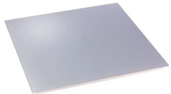
Bei Heizelementen der Baureihe VH hört das Heizmedium 35 mm vor dem Rand der Glasscheibe auf. Da das Glas in diesem Bereich nicht direkt erhitzt wird und Glas ein schlechter Wärmeleiter ist, fällt die Oberflächentemperatur so schnell ab, dass das U-Profil der Systemdecke auf dem das Heizelement aufliegt, nicht mehr als 60 Kelvin über die Umgebungstemperatur erwärmt wird.
